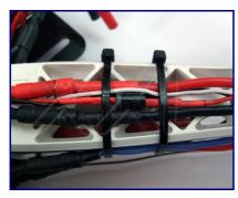
Die Schottky-Dioden werden einfach in die mittlere (rote) Leitung der drei Anschlußkabel für die Flugregler gelötet. Der Streifen zeigt die Sperrrichtung an und muß vom Regler weg zeigen. Die Anschlüsse müssen gut mit Schrumpfschlauch vor abknicken geschütz werden. Sie finden die Schottky-Dioden bei uns im Shop.
