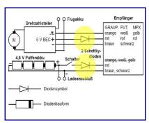
Wichtiger Hinweis zu den Motorreglern. Um die BEC-Funktion aller Regler nutzen zu können, ist es notwendig eine Schottky-Diode in die 5V Leitung einzulöten. Sie können natürlich auch standardmäßig nur einen Regler mit BEC anschließen. Der Schaltplan zeigt die Schaltung bei der Verwendung mehrerer Spannungsquellen für das BEC.
